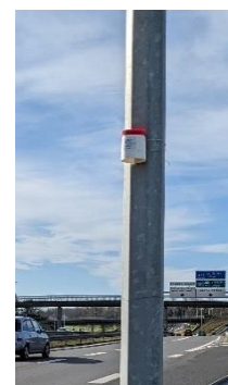
Figure 4 : dispositif de mesure par tube passif sur site
