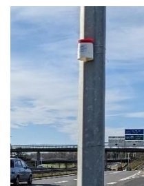
Figure 4 : dispositif de mesure par tube passif sur site
