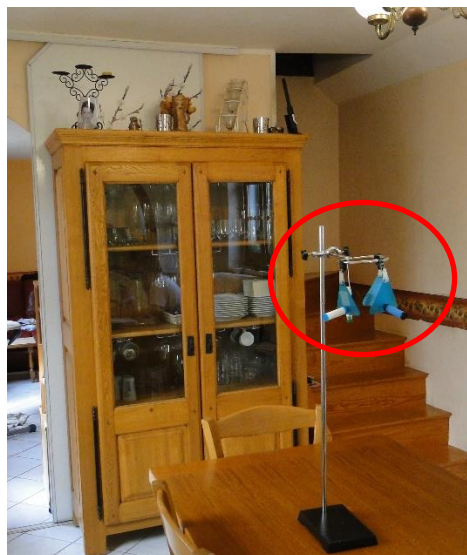
Figure 20 : dispositif de mesure en air intérieur à La Caroline
