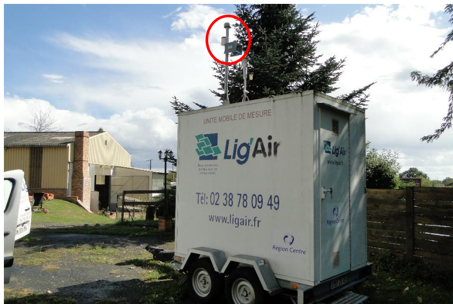
Figure 23 : moyens mobiles de mesures installés au Pic Montaigu et dispositif de mesure en air extérieur à proximité du moyen mobile
