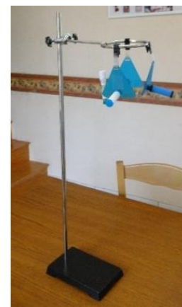
Figure 5 : dispositif de prélèvement par tube passif
