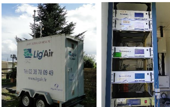
Figure 4 : station mobile de Lig'Air (extérieur et intérieur)
