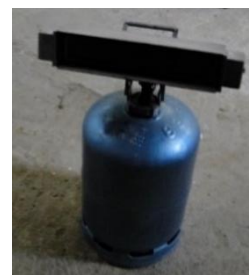
Figure 17 : radiateur sur bouteille de gaz
