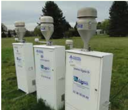
PHOTO 2 : PRÉLÈVEURS DE PARTICULES EN SUSPENSION PM 10 SUR LE SITE D'ORLÉANS-LA SOURCE EN 2015
