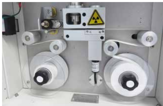
PHOTO 2 : PRÉLEVEUR PARTICULES PAR RAYONNEMENT BÊTA
