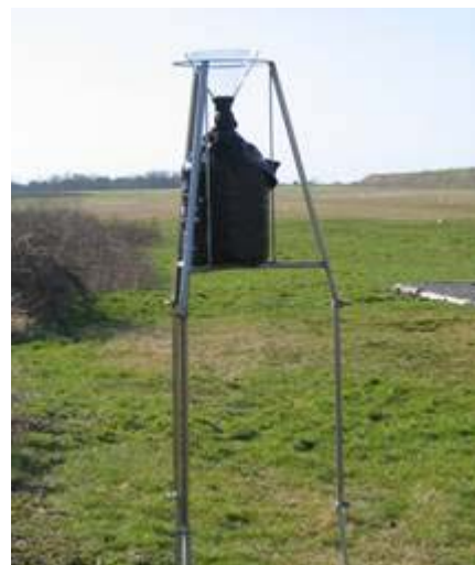
Photo 1 : Préleveur passif type Jauge Owen sur trépied
