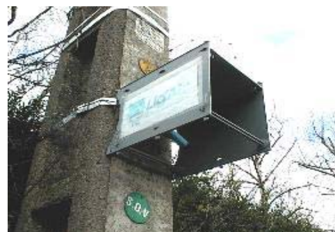
Photo 1 : tube passif mesurant le benzène
