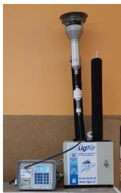
Figure 8 : dispositif de prélèvement en air intérieur
